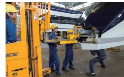
連結器メンテナンス（京成車両工業）
