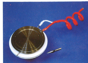
VVVFインバータ装置 4500V 2000A GTOサイリスタ
