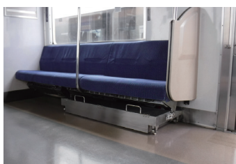
乗降用扉設置用(収納時)
