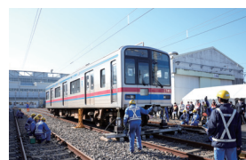
脱線復旧の様子
