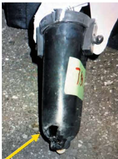
破損したケース
