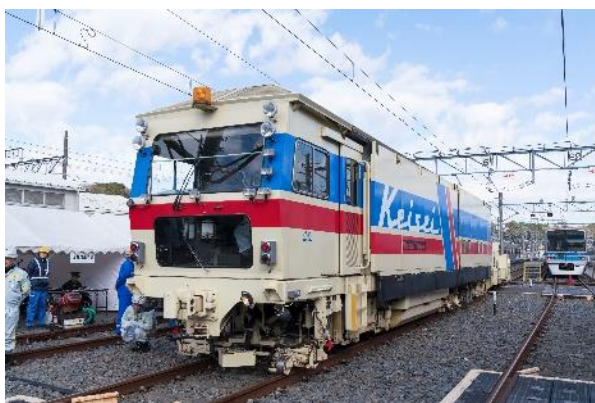
搗き固めを行うマルチプルタイタンパー
