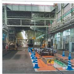
分解された車両。 左車体部分 右台車部分
