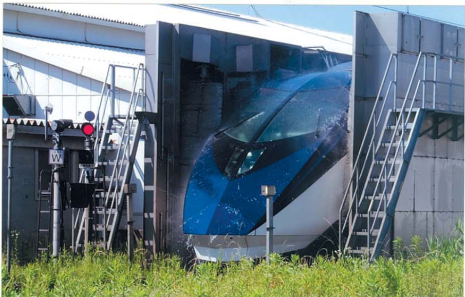
洗車しているスカイライナー
