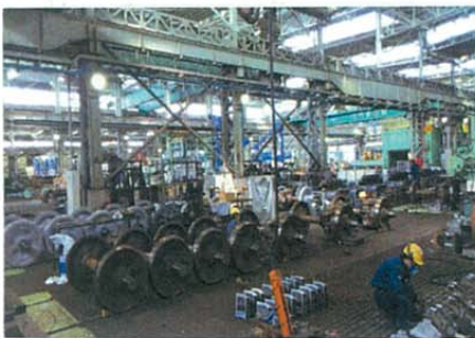
分解された車輪ひとつひとつ細かくチェックされる。
