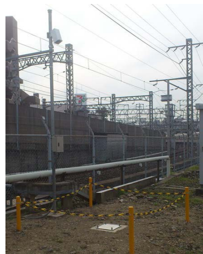
積雪量計 (地上へのレーザーの跳ね返りで計測)
