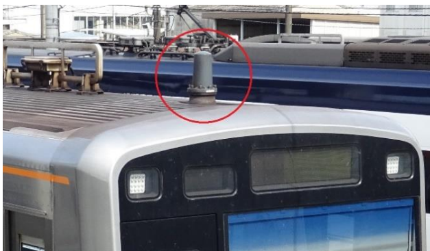
<車上設備 アンテナ>
